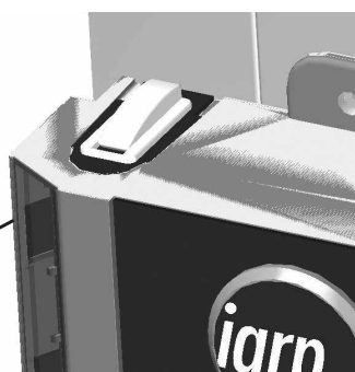
Microinterrupteur du ventilateur intérieur (avec la porte ouverte: ventilateur deconnectée)
